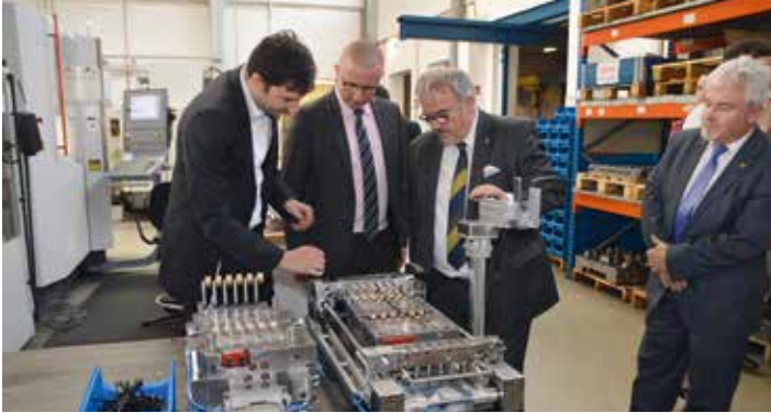
Geschäftsführer Martin Dietze (links) zeigt ein komplexes Werkzeug zur Herstellung eines Steckers mit Knickschutz, das bald nach Mexiko ausgeliefert wird
